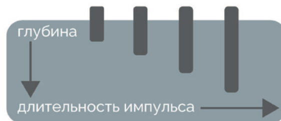
Фото 36. Микроколонна. Глубина микроколонны зависит от времени воздействия луча лазера - длины импульса
