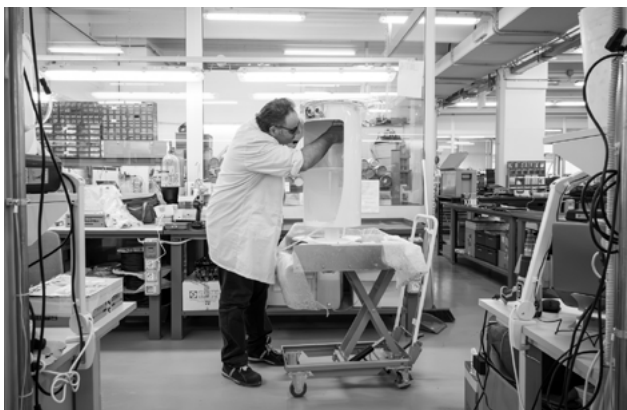
Фото 4. Аппараты собираются в производственных цехах на собственной фабрике Biotec Italia. При сборке характеристики аппаратов последовательно проверяются большим количеством специальных измерительных приборов
