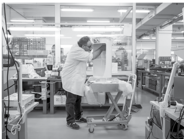
Фото 4. Аппараты собираются в производственных цехах на собственной фабрике Biotec Italia. При сборке характеристики аппаратов последовательно проверяются большим количеством специальных измерительных приборов
